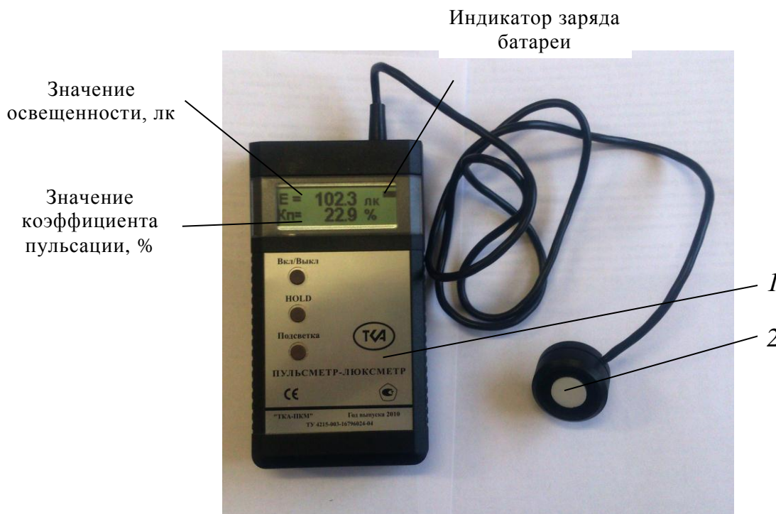
Рис. 3.2. Общий вид люксметра-пульсметра ТКА-ПКМ (08): 1 – блок управления и индикации; 2 – фотоэлемент.
